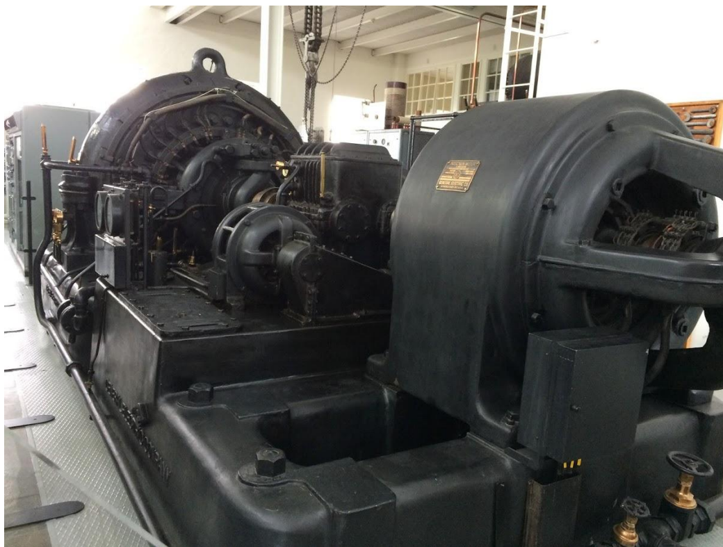
3. Långvågssändaren bestående av elmotor, växellåda samt generator
